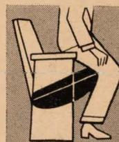
Suprimida a pressão das pernas, o assento volta a posição em 3/4 do percurso e o espectador o abaixa suavemente com o peso do próprio corpo, sem precisar forçá-lo com as mãos.
